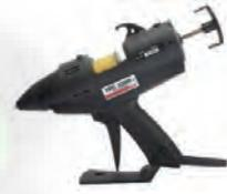
2) **Référence A106.340039** : Pistolet standard, Micro-circuit électronique intégré Soupape anti-coulure chambre de fusion à haute performance l'avance mécanique évite la fatigue. Débit maximum : 500 g/h Puissance maximale : 100 watts. Préchauffage mini : 1,5 minutes Colle transparente Ø12 x 190mm - 1kg : **référence A106.667277**
